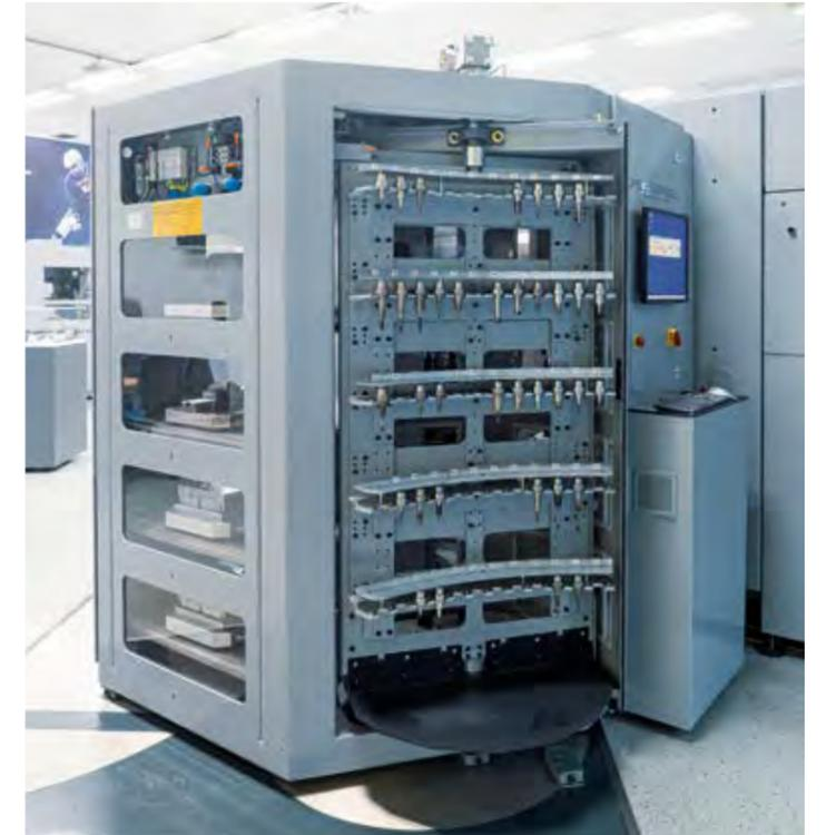
So können mit dem MultiChange *plusTools* Werkstückpaletten, Elektrodenhalter und Fräswerkzeuge mit nur einem Handlingsystem gehandhabt werden. Die Roboterzelle kann sowohl die HSC- und EDM-Technologie, als auch beide in Kombination bedienen.
