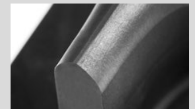
Verschleiß EAGLE PowerSPARK: 21 µm
